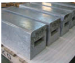
ジオポリマーで製作した外構ブロック
