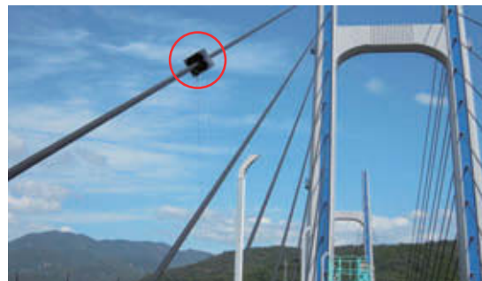
「コロコロチェッカー」による斜材外観調査の様様
