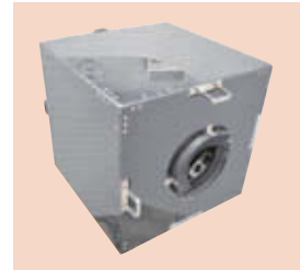
自走式斜材外観調査ロボット 「コロコロチェッカー」
