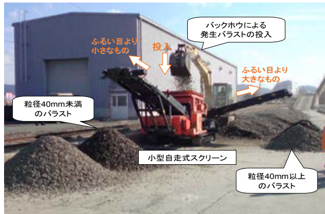
(写真) 小型自走式スクリーンを用いたふるい分け作業
