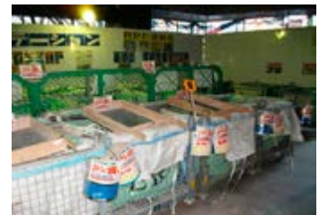
・各分別ボックスにふるいと磁選機を設置
