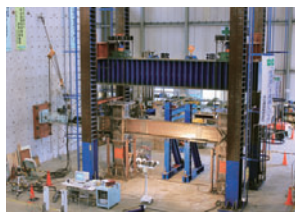
実物大実験状況 (BiDフレーム工法)
