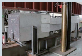
合成梁載荷実験状況
