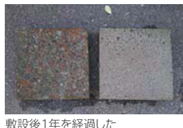
敷設後1年を経過した『ジオポリマー』(右)とセメントコンクリート(左)
