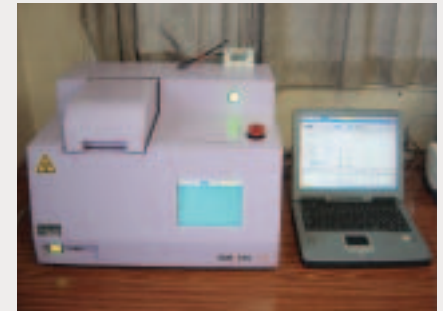
蛍光X線分析装置を用いた簡易迅速分析技術（重金属）
