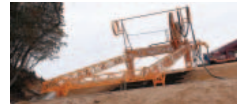
長大・多段のり面吹付装置
