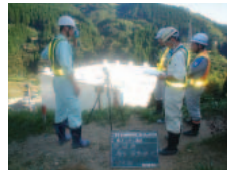
発破騒音測定状況
