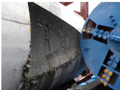
架台上的切削性確認実験
