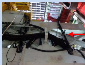
レーザ距離計をシールドマシン機内に取り付け
