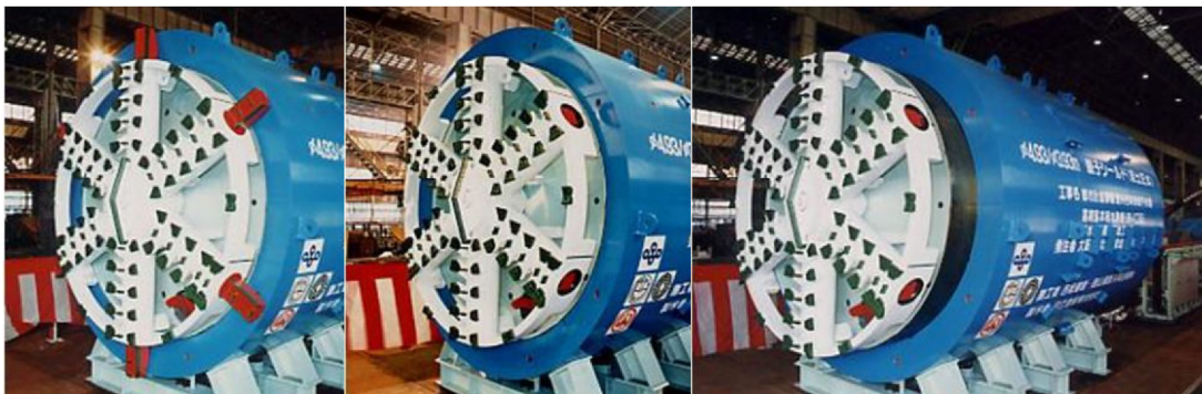
親子シールド機、作動状況写真
