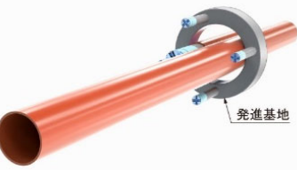
図1 小口径シールド発進基地
