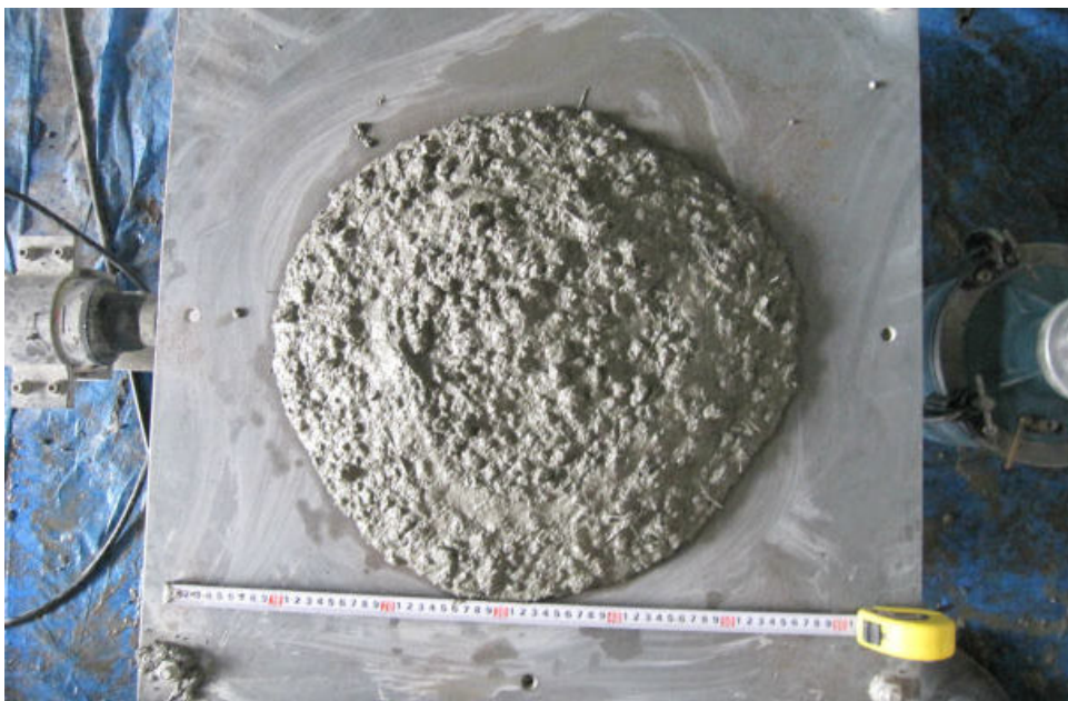
▲スランプフロー 45.3cm(平均) 増粘剤一液型高性能AE減水剤 短繊維 0.3vol.%
