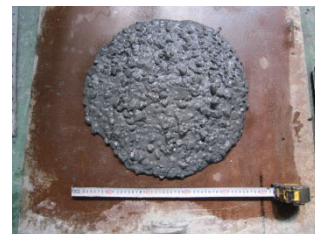
③スランプフロー測定
