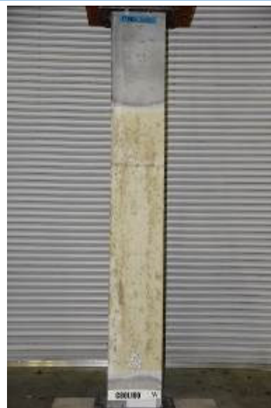
PP繊維を混入した 鉄筋コンクリート柱の加熱試験後の状況
