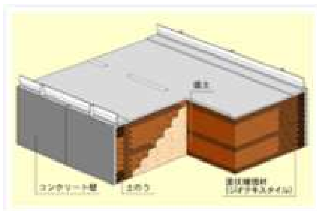
補強盛土工法
