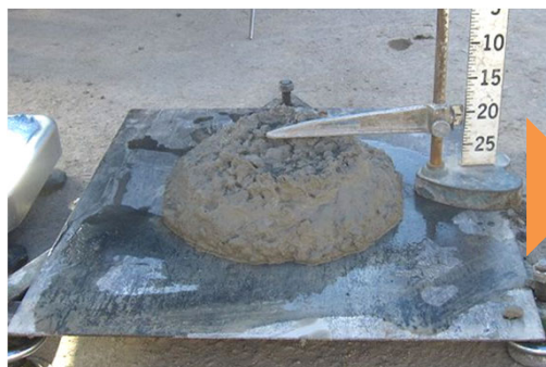
▲到着したベースコンクリート スランプ20.5cm
