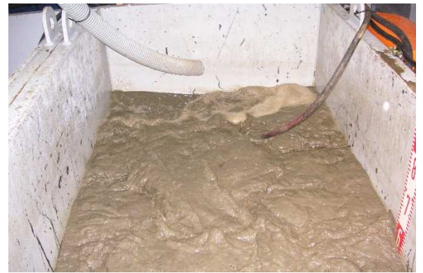
実証実験の状況（攪拌による抽出除去）
