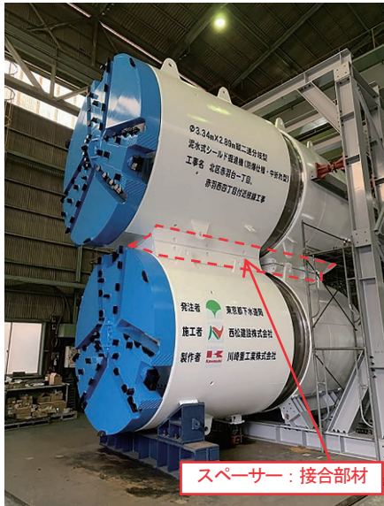
写真-1 縦二連分岐型H&Vシールド機
