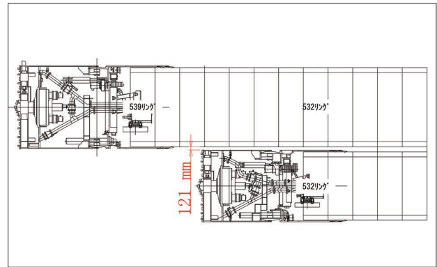
図-7 上下段シールド掘削時の位置関係
