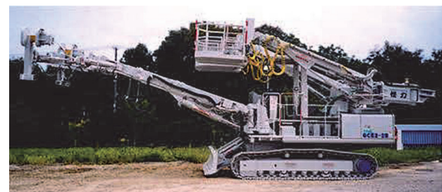
写真-1 支保工建込みエレクタ
