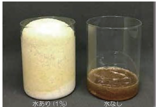
写真-4 湧水抑制材(水発泡ウレタン)固結状況
