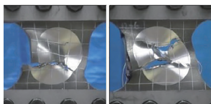
(d) type12-7 (e) type12-6 写真-1 最終破壊状況
