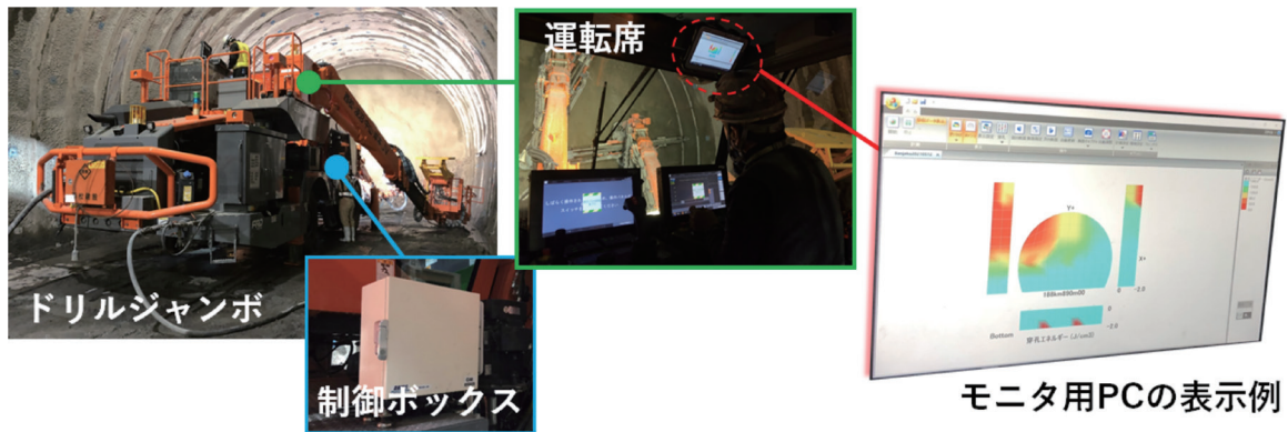
図-2 ドリルジャンボに搭載した制御ボックスとモニタ用PC
