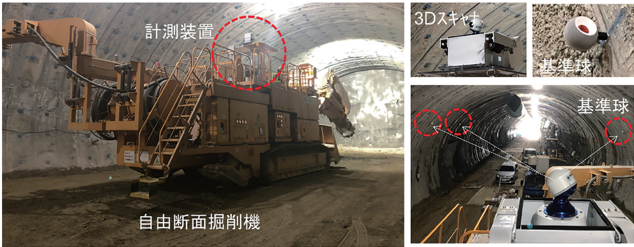
図一 高速 3D スキャナによる機体位置・姿勢測定
