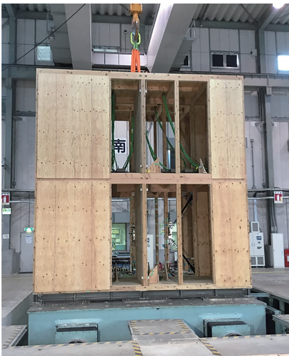
写真一 木造制振建築物実大試験体
