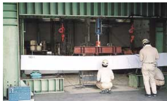
西松建設(株)技術研究所 大型実験棟内 補強材の重ね継手実験状況
