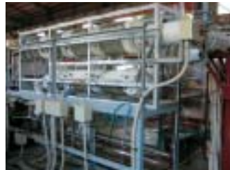
反応器 揮発させたガスを1～2秒で完全に分解して無害にする部分
