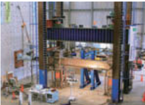
実物大実験状況(BiDフレーム工法)
