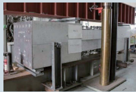
合成梁載荷実験状況
