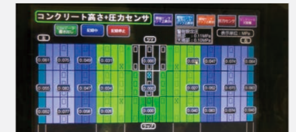
コンクリート打設高さ・圧力をリアルタイム表示
