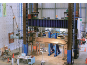
実物大実験状況(BiDフレーム工法)
