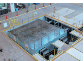
3次元大型振動実験装置
