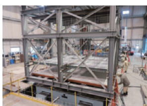
天井板取付状況(耐震クリップ実験)
