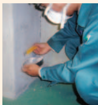
アスベスト分析調査検体採取状況
