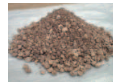
ALCくず → 人工軽量土 植栽工事で使用
