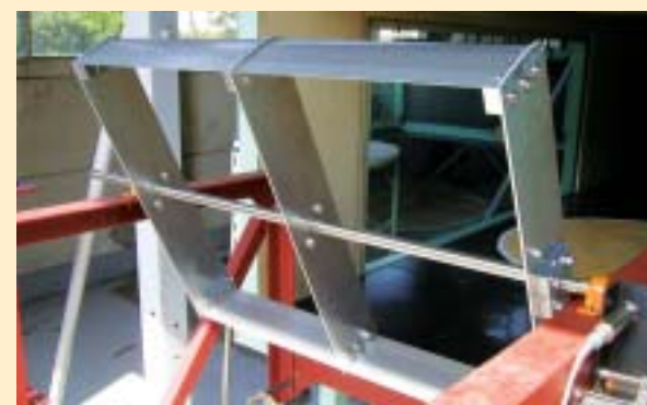
風洞実験模型 注:本開発は、東北大学未来科学技術共同研究センター主催の未来都市風力発電研究会の活動に基づいて行われています。
