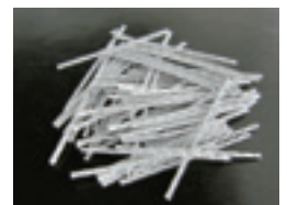
LX30 Fiber diameter 0.68mm× fiber length 30mm
