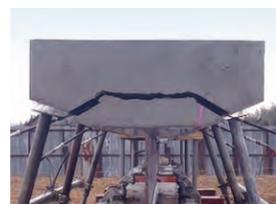
板ジャッキによる割裂実験
