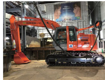
場内CO 2 排出ゼロの電動バックホウを使用
