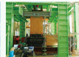
柱梁接合部の剛性、耐力確認試験 加力ジャッキにより、柱梁接合部に水平力（地震力に相当）をかけて、柱梁接合部の剛性、耐力を確認する試験
