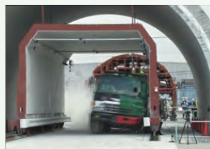
防護工技術開発実大衝突実験
