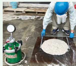
コンクリートのフレッシュ性状
