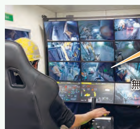
ホイールローダ遠隔操作システム（Tunnel RemOS-WL）の現場適用試験状況
