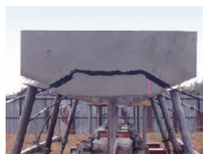
板ジャッキによる割裂実験
