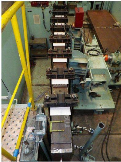
供試体の曲げ耐力確認試験
