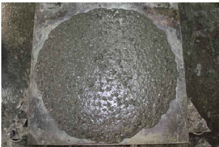
写真1 超高強度コンクリートのスランプフロー
