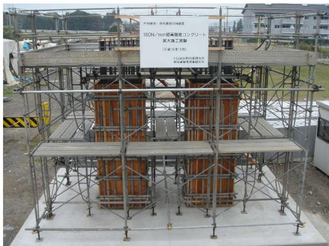
写真2 超高強度コンクリートによる柱部材の施工試験
