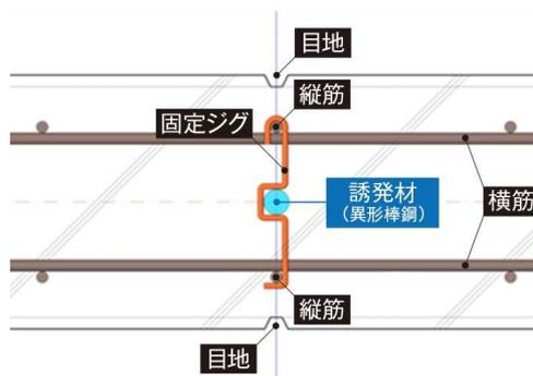
耐力壁表面の増し打ち部に設けた欠き込み目地と壁断面中央部のひび割れ誘発材および壁縦筋を直線上に配置し、コンクリート打設中に誘発材が移動しないよう、専用の固定ジグを用います。
