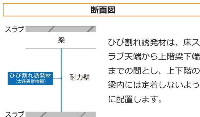
ひび割れ誘発材は、床スラブ天端から上階梁下端までの間とし、上下階の梁内には定着しないように配置します。
