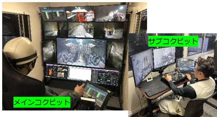
遠隔操作室内 (モニタ&コクピット)
