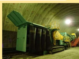
【自走式クラッシャー】 切羽進行に追従して 最大20m程度前進可能
