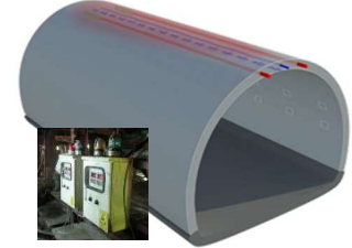
④ 加圧充填施工
