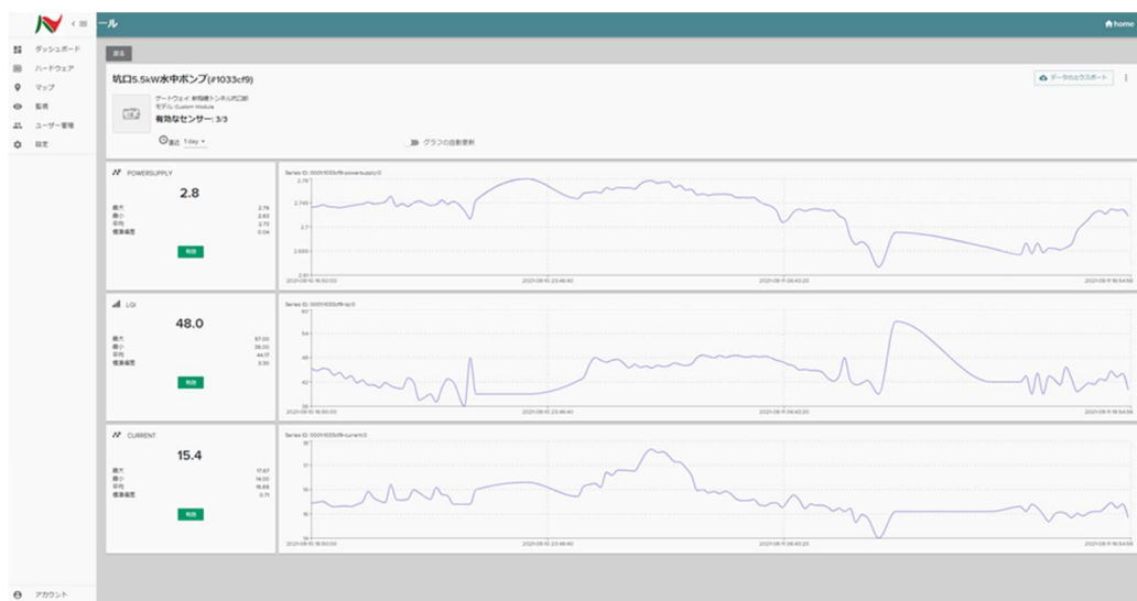
水中ポンプの稼働監視状況
