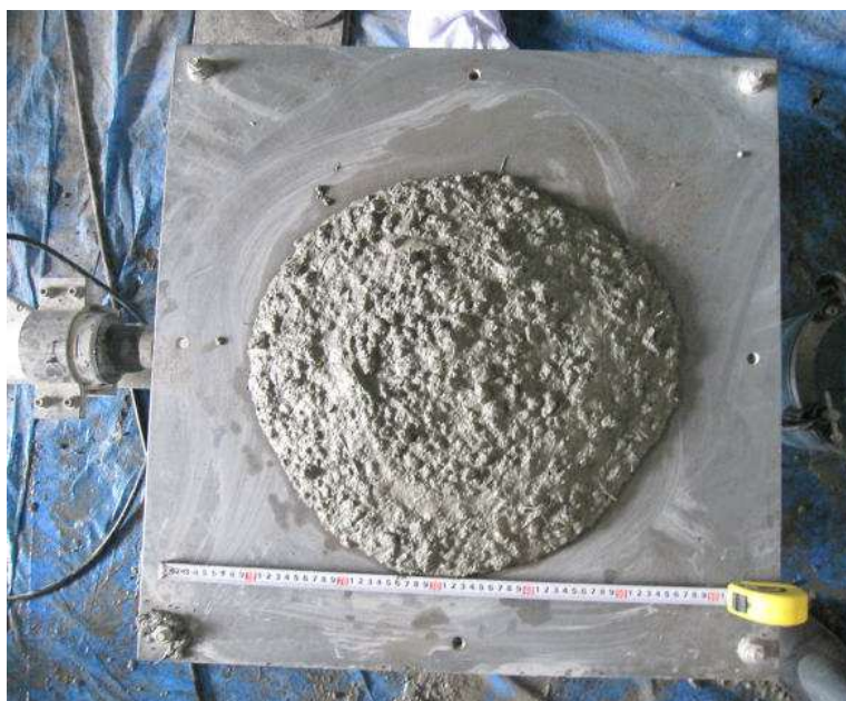
▲スランプフロー 45.3cm(平均) 増粘剤一液型高性能AE減水剤 短繊維 0.3vol. %
