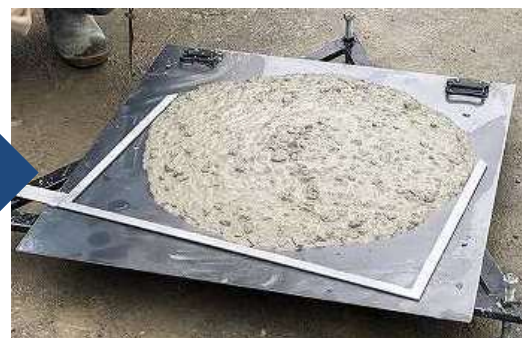
▲後添加後のコンクリート スランプフロー 65.0×67.5cm (高流動ランク2相当)
