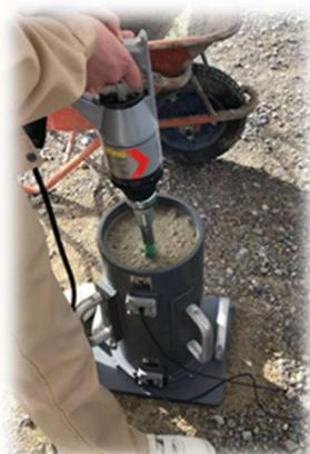
バイブレータで60秒間の加振をしながら伝導率を計測
