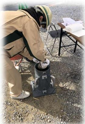
試験機に高さ400mmまでコンクリートを投入(約14L)
