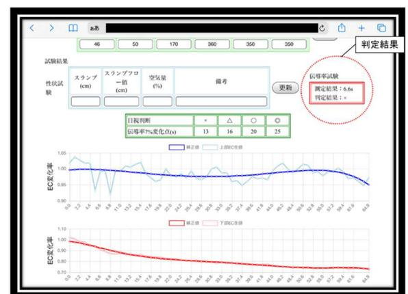
伝導率の変化を用いて材料分離抵抗性を数値化・評価
