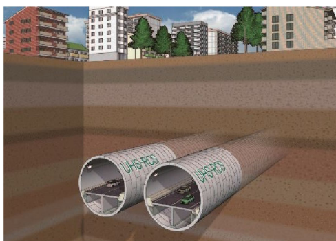
図－1 超高強度RCセグメント を使用したシールドトンネル
