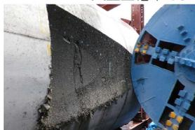
架台上的切削性確認実験
