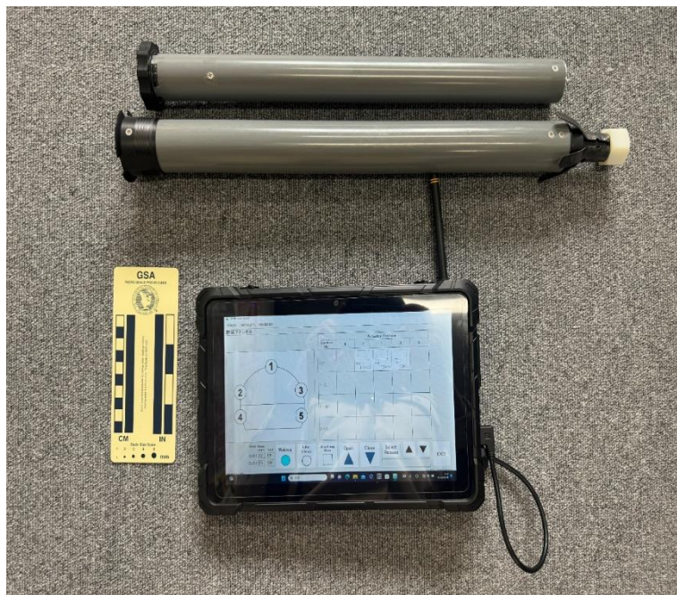
上よりプリズム伸縮装置、固定筒、リモコン
