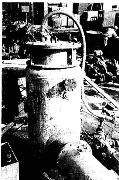
Photo 1 スクリューコンベア先端部レシーバタンク
